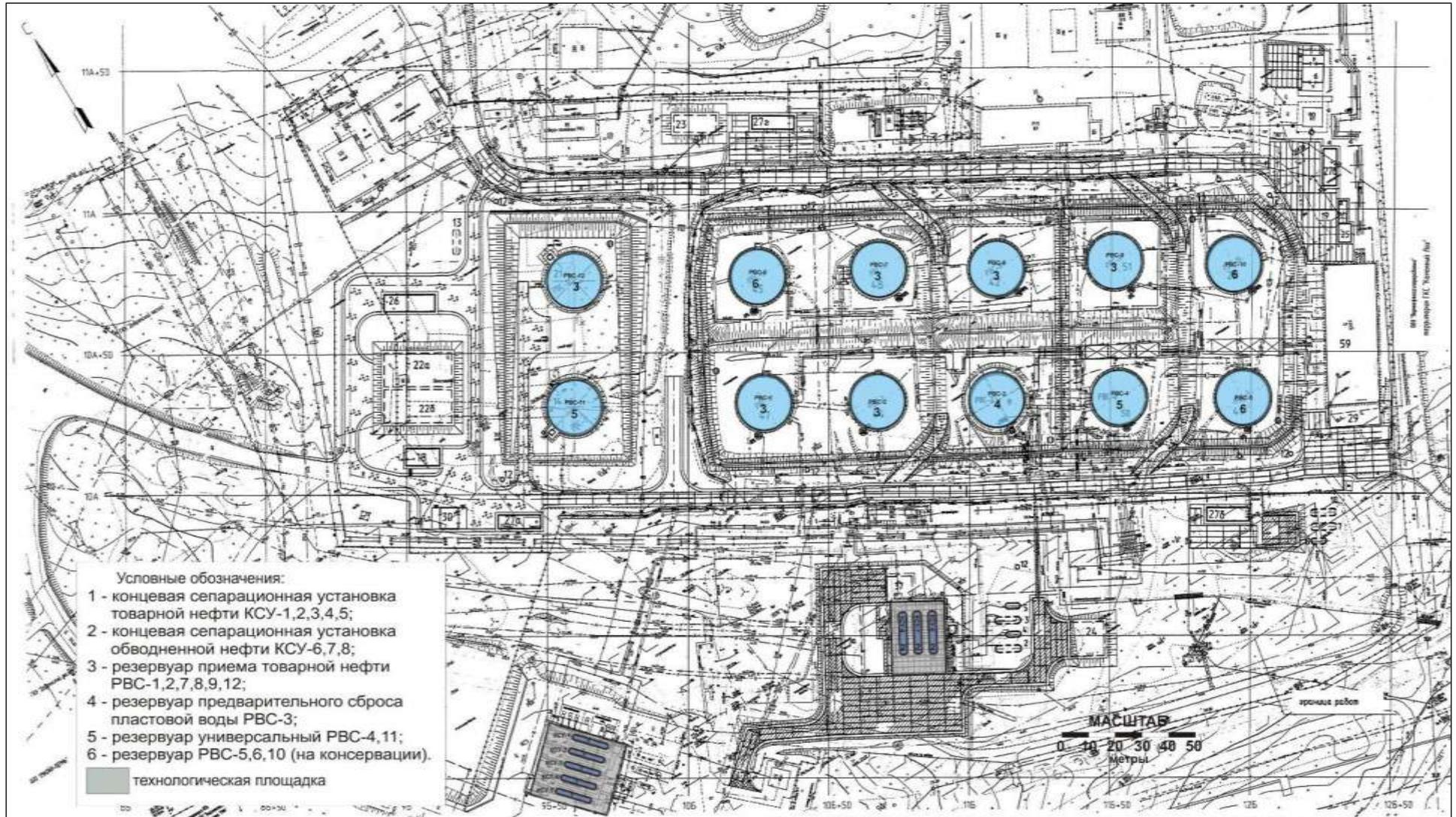
Рисунок 21. План расположения оборудования ПСП УПН «Каменный Лог» ЦДНГ-11 ООО «ЛУКОЙЛ-ПЕРМЬ»
