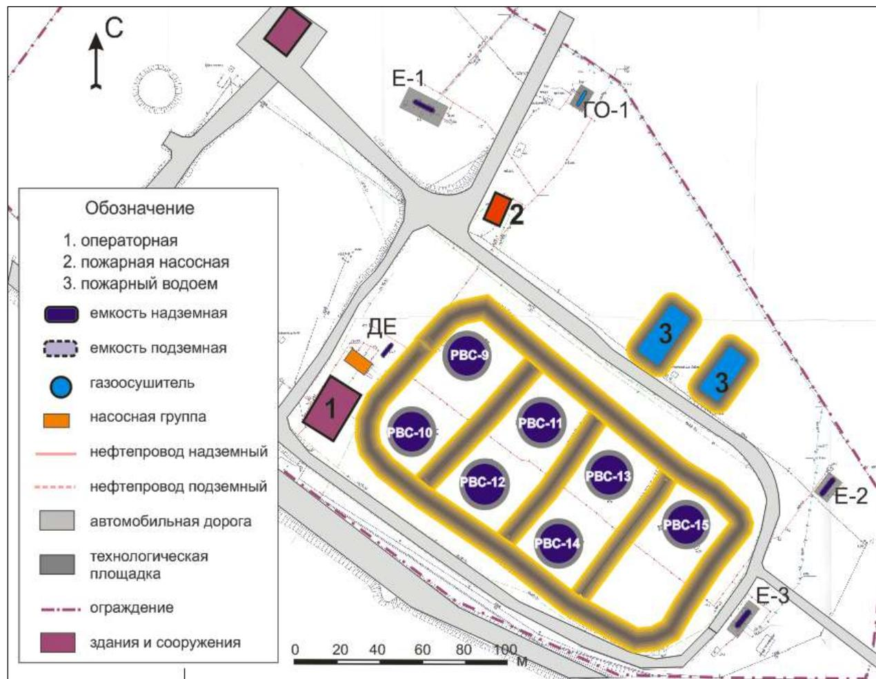
Рисунок 10. План расположения оборудования УПСВ-0413 «Ярино» ЦДНГ-4
