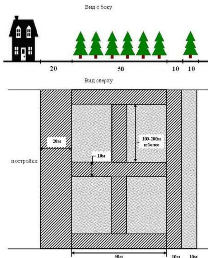
Рисунок 1 – Параметры пожароустойчивой полосы шириной 90 метров
